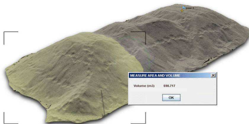
Figure 1 - Exemple d'une cubature réalisée dans une carrière de granulats
