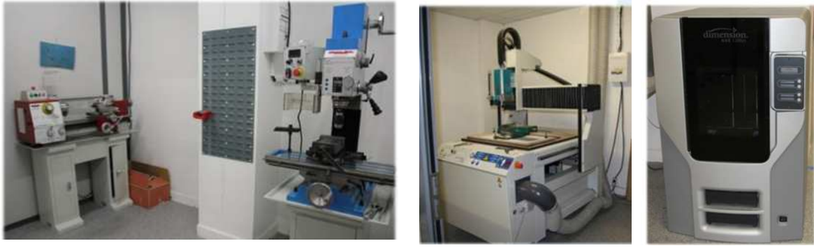
Figure 13 - Fabrication mécanique : fraiseuse CNC, fraiseuse, tour, imprimante 3D
